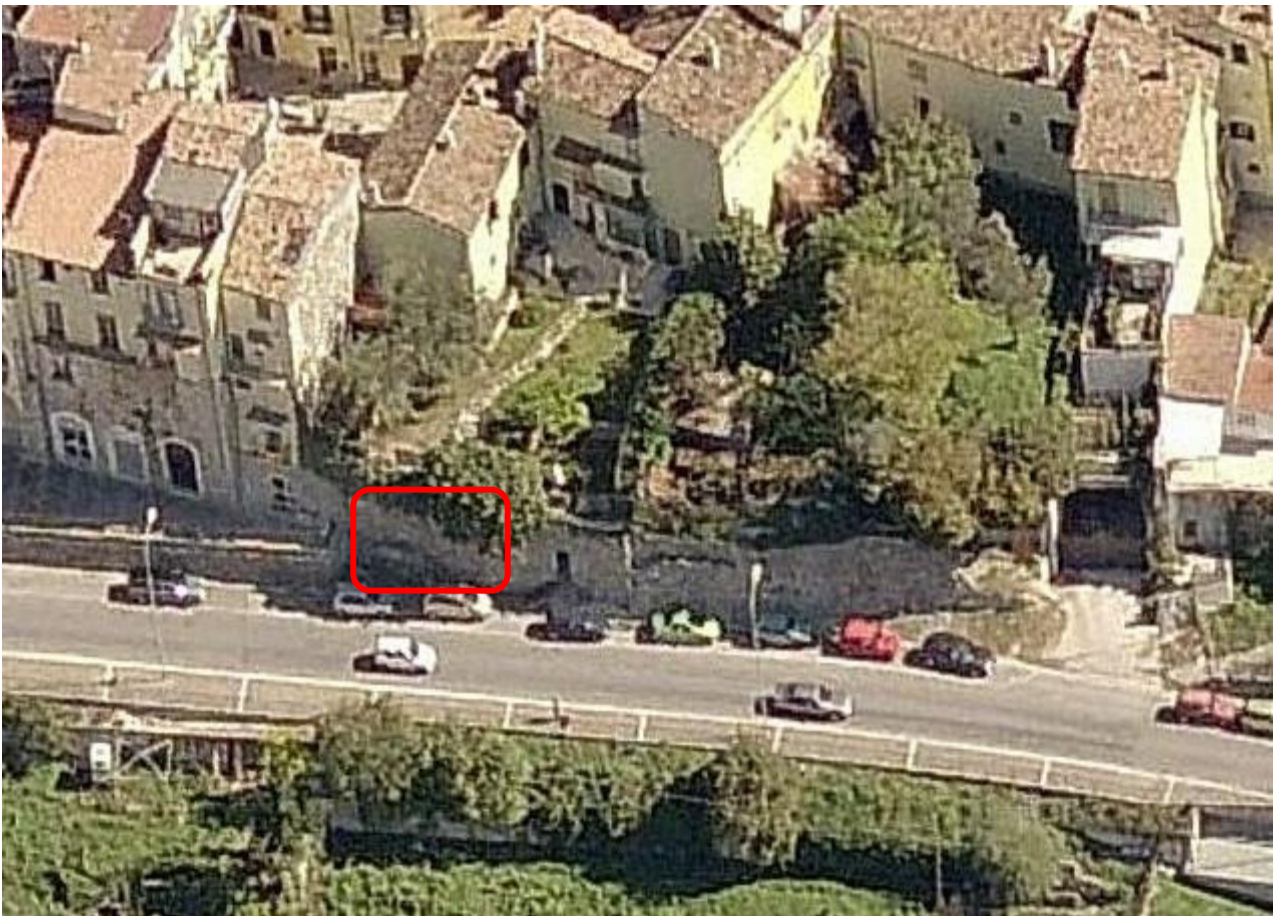
Foto n. 3 – Visione aerea da Ovest del muro di cinta del Borgo Antico. Nel riquadro è indicata la parte che è implosa su sé stessa.
