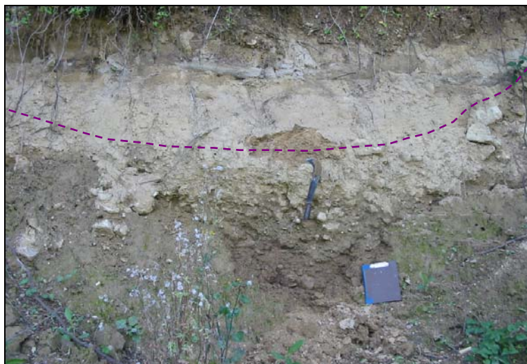
Foto 2 Associazione di limi argillo-sabbiosi e sabbie limose a costituire una spessa lente avana-giallastra intercalata nei depositi ghiaiosi; verso l'alto, si nota un sottile livello di sabbia limosa grigia cementata che separa la porzione limosa della lente da quella sabbiosa superiore.
