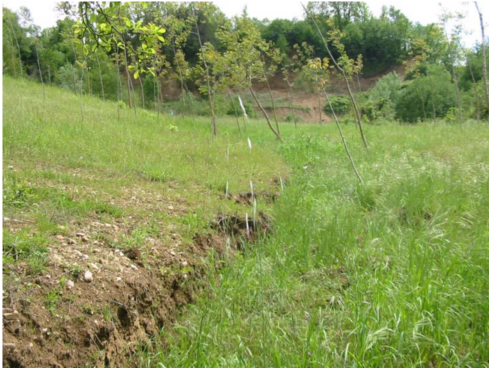
Foto 5 - Si notano le fratture del terreno localizzate nella parte inferiore del versante
