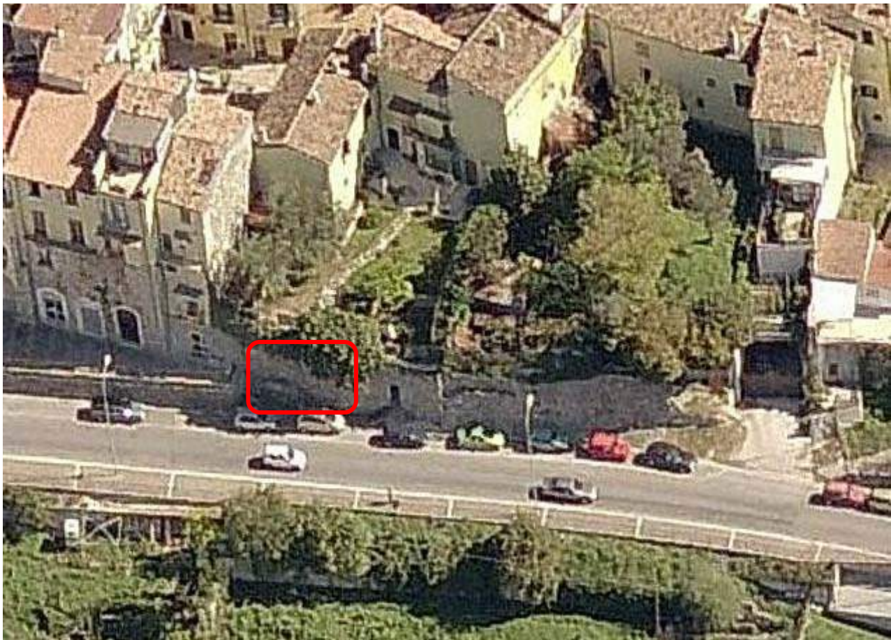
Visione aerea da Ovest del muro di cinta del Borgo Antico. Nel riquadro è indicata la parte che è implosa su se stessa
