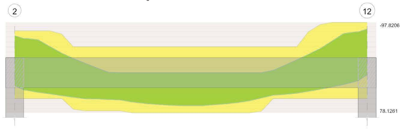
Diagramma verifica stato limite ultimo taglio
