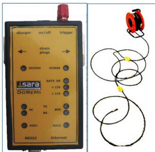
Fig. 2: sismografo DoReMi e Cavo di registrazione.
