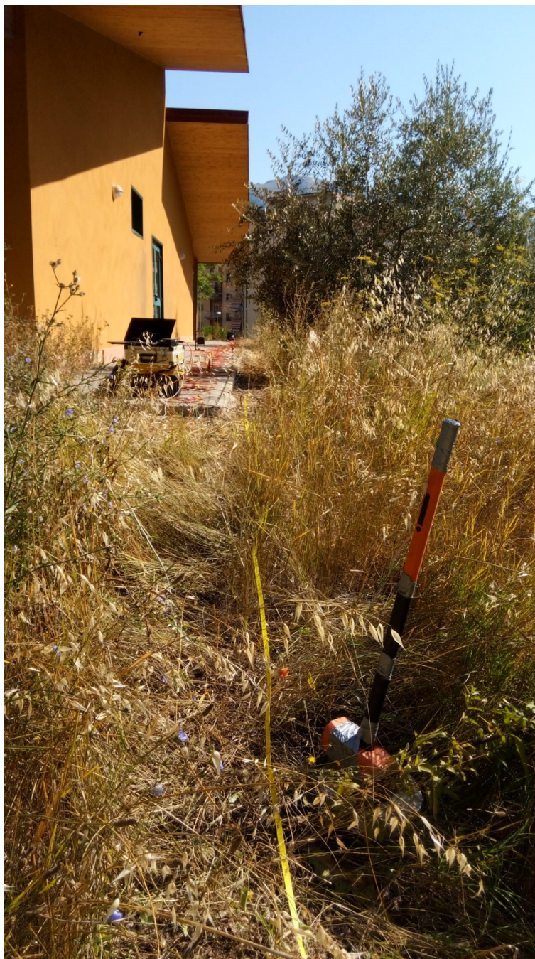
FOTO 1: stendimento sismico MASW.
