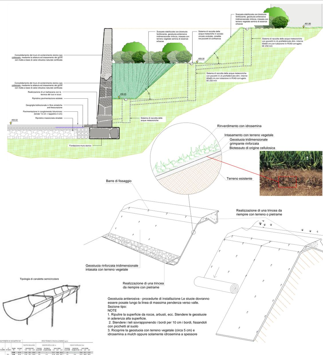
Geostuoia antierosiva - procedure di installazione Le stuoie dovranno essere posate lungo la linea di massima pendenza verso valle.
