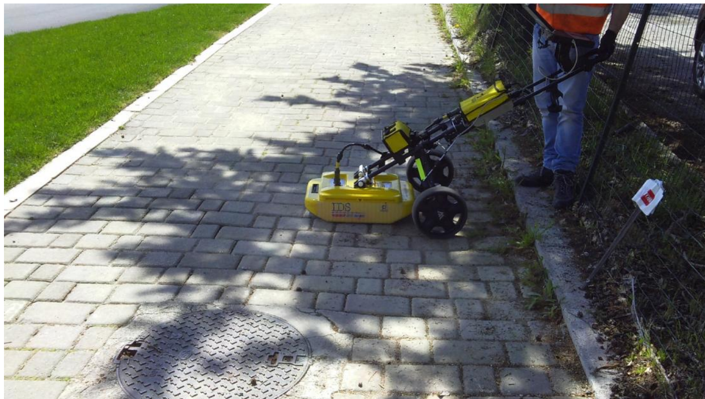
FIGURA 6: GPR UTILIZZATO IN SITO
