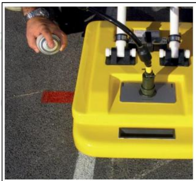
FIGURA 7: ESEMPIO DI RITROVAMENTO DI SOTTOSERVIZIO
